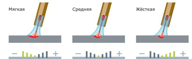
Регулировка динамики позволяет формировать более широкую или узкую сварочную дугу – по желанию сварщика.
