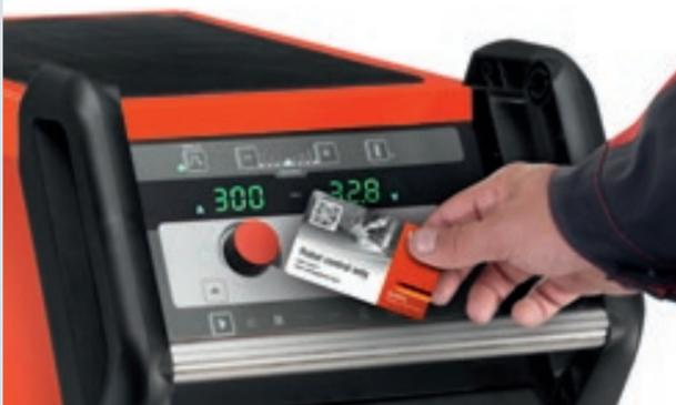
Благодаря технологии NFC с бесконтактной передачей данных идентификация и авторизация пользователя возможна в любое время. В серийном исполнении аппарат поставляется с двумя картами доступа: «Администратор» и «Robot control only».
