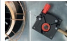
2-х роликовый механизм подачи проволоки
