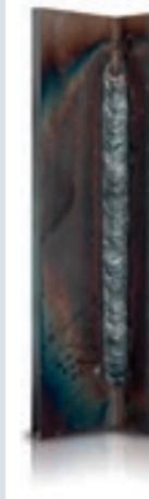
Вам больше не нужно осуществлять колебательные движения электродом. Вы можете просто вести его прямо вверх. Благодаря запатентованной регулирующей технике технология MicorBoost обеспечивает достаточно мощности для поддержания стабильности ванны расплавленного металла и сварочной дуги. Кроме того, больше нет необходимости сваривать в два прохода, поскольку достаточно одного с электродом большего диаметра.
