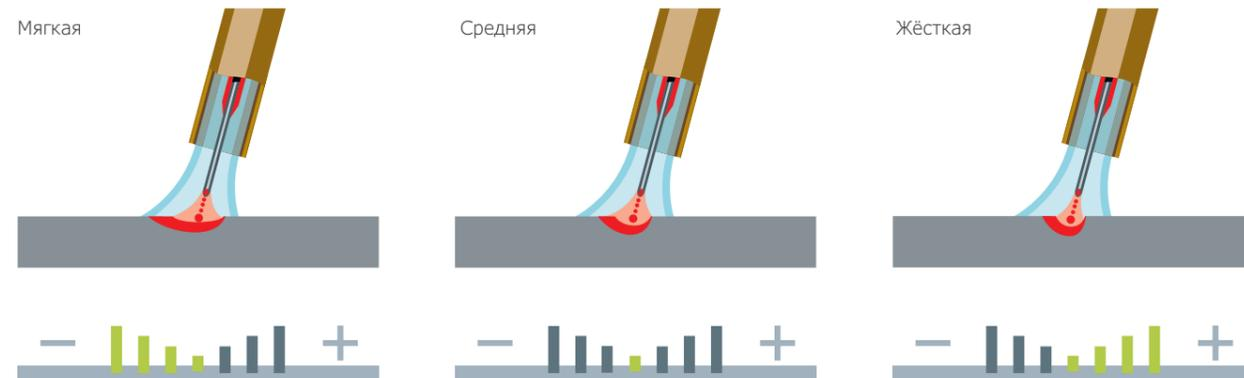
Регулировка динамики позволяет формировать более широкую или узкую сварочную дугу – по желанию сварщика.
