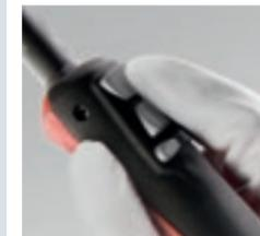
Благодаря сварочной горелке с дистанционным управлением и функцией «UpDown» Вы находитесь на месте развития событий, то есть непосредственно у обрабатываемой детали. Вы держите сварочную горелку в руке, управляете с ее помощью сварочным процессом и вместе с тем регулируете также сварочный ток с точностью до ампера.
