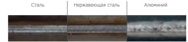
**Интеллектуальное решение от Lorch:** Неважно, идёт ли речь о стали, нержавеющей стали или алюминии. Быстрая регулирующая техника и проверенная на практике импульсная сварочная дуга MicorMIG обеспечивают сварку практически без брызг даже в области переходной дуги, избавляя Вас от обременительной обработки шва после сварки.
