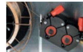
4-х роликовый механизм подачи проволоки
