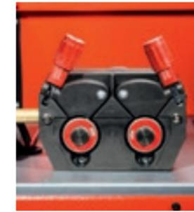
4-х роликовый механизм подачи проволоки
