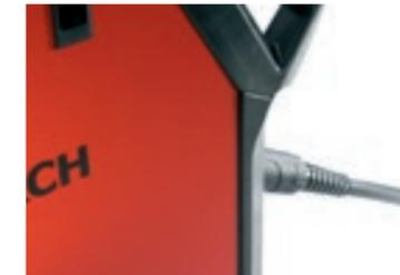
Оптимизированный свободный ход проволоки благодаря подключению горелки под углом
