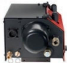
Функционально оптимизированное подключение для кабеля управления, подачи газа, сжатого воздуха, проволоки и сварочного тока (надёжное соединение посредством кабельных наконечников).
