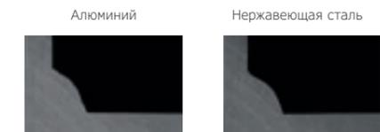
**Интеллектуальное решение от Lorch:** сварной шов без брызг, мягкие зоны перехода шва к основному металлу и лучшее оплавление кромок. Благодаря импульсной сварочной дуге MicorMIG и простоте управления теперь Вы справитесь с задачей без труда.
