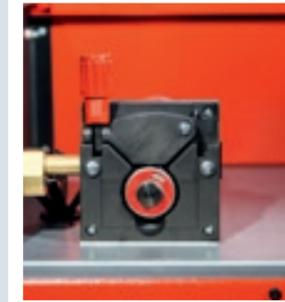
2-х роликовый механизм подачи проволоки
